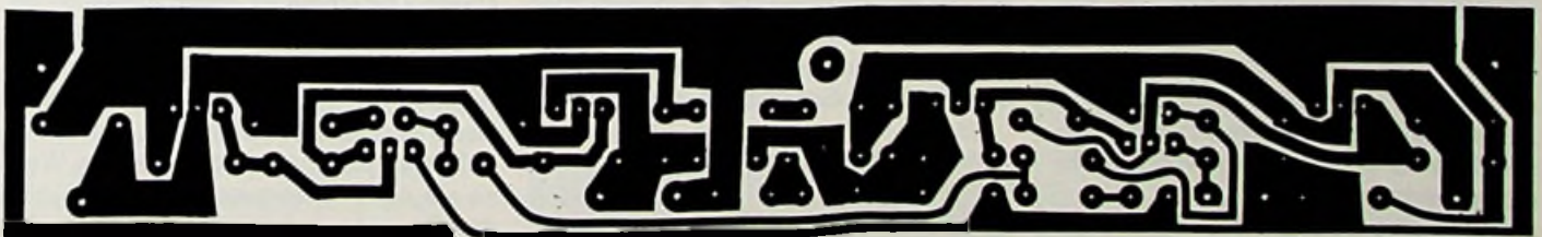
Bild 5: Platinen-Layout des 200-W-Brückenverstärker
