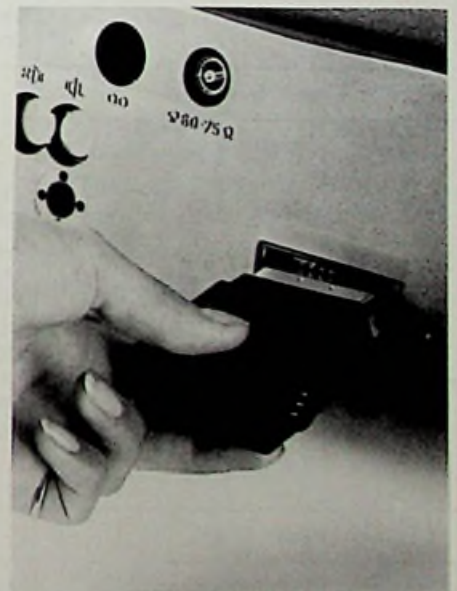
Bild 4: Alte und neue Stecksysteme können über Adapter miteinander kombiniert werden Bild: SABA-Pressebild
